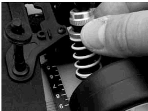
Les réglage standards de hauteur de châssis sont 4 mm à l'avant et 6 mm à l'arrière.
