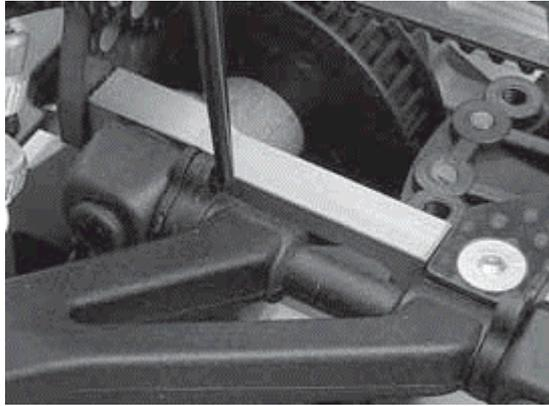
6. Ajuster(compenser) la Chasse aux réglages désirables en jouant sur de transfert des bagues de réglages prévues à cet effet. Leur épaisseurs sont généralement de 1 , 2 et 3 mm.
