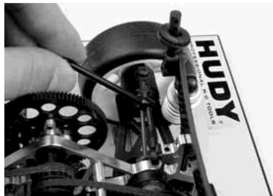
Les réglage standards de carrossage sont d'environ 1° à l'avant et 2° à l'arrière.
